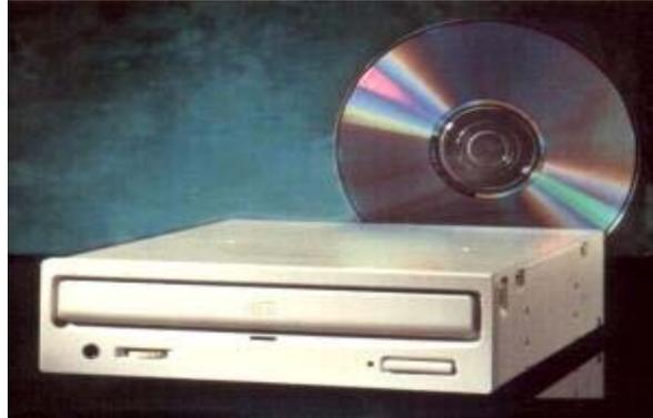
Los discos ópticos presentan una capa interna protegida, donde se guardan los bits mediante distintas tecnologías, siendo que en todas ellas dichos bits se leen merced a un rayo láser incidente. Este, al ser reflejado, permite detectar variaciones microscópicas de propiedades óptico-reflectivas ocurridas como consecuencia de la grabación realizada en la escritura. Un sistema óptico con lentes encamina el haz luminoso, y lo enfoca como un punto en la capa del disco que almacena los datos.
